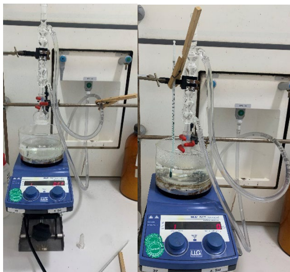
Forsøgsopstilling. Venstre foto viser bl.a., hvordan varmepladen står på en løfteplade. Foto til højre viser hvordan termometer er fastholdt i vandbadet.
