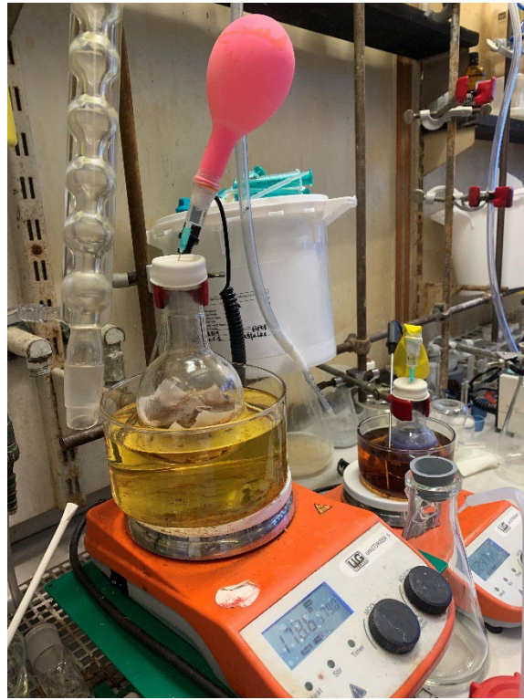
Figur 4. Forsøgsopstilling med gummiseptum monteret efter forsøget er færdigt.
