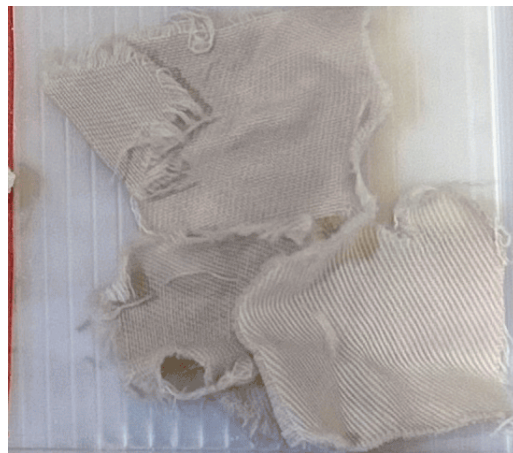
Figur 2. Kittelstykke efter recyclingforsøget. Nu kun bomuld uden polyester. Bemærk at det ikke er samme kittelstykke, desværre.
