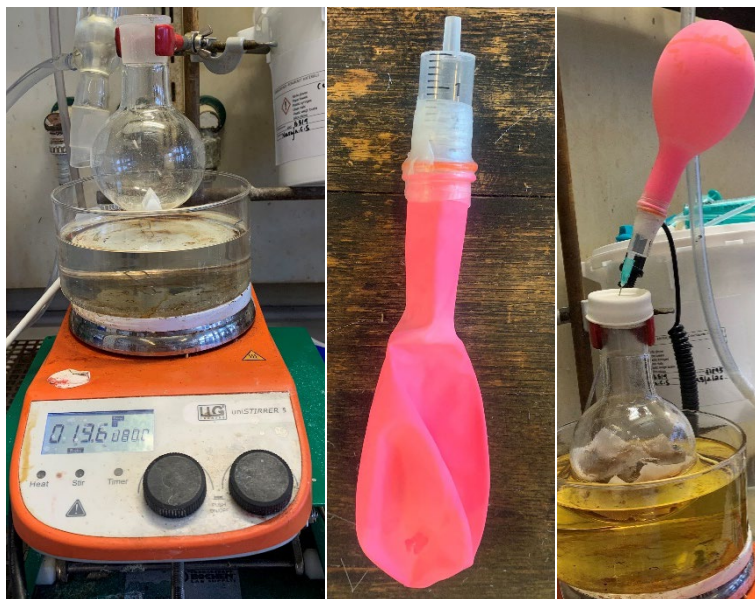
Figur 2. Forsøgsopstilling. Den rundbundede kolbe fikseres og placeres i vandbad på en varmeplade med magnetomrøring. I midten er vist hvordan en 2 ml kanyle påklistres en ballon. På billedet her er kanylen skåret over for at blive afkortet. Til sidst påsættes kanylen med ballon en kanylespids, og kanylespiden føres ned gennem gummiseptum.
