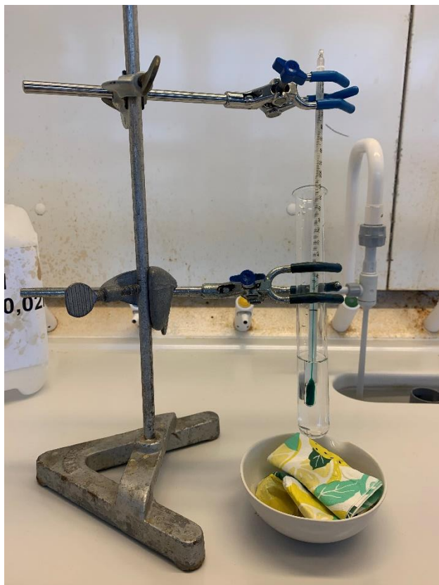
Figur 2. Forsøgsopstilling for bestemmelse af energiindhold i restaffald, eksemplificeret ved servietter.
