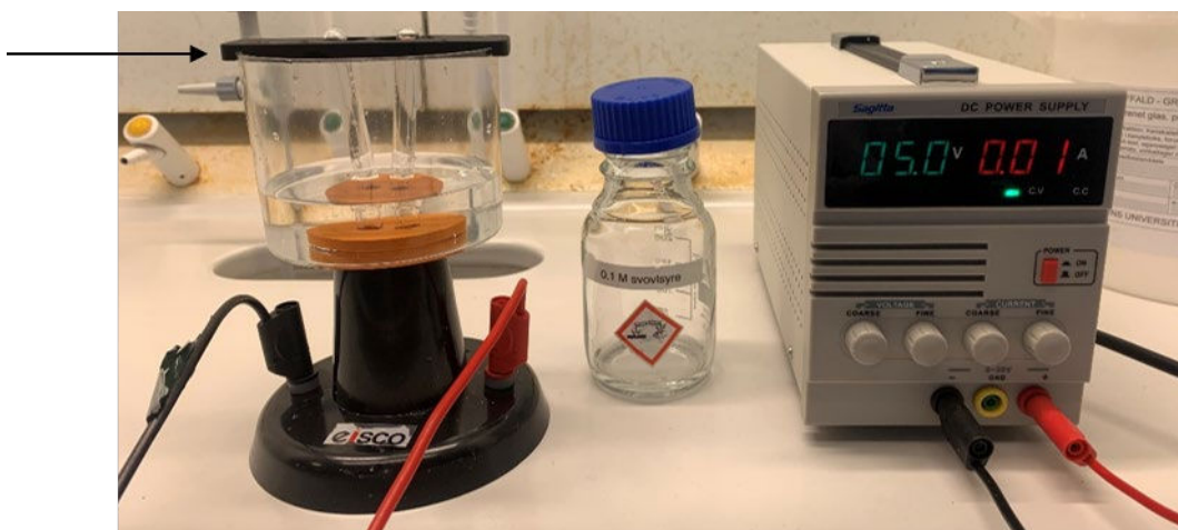
Figur 1. Forsøgsoptstilling med elektrolysekar. Som pilen markerer, har dette elektrolysekar en lille plastpind over elektrolysekarret, der fastholder reagensglassene over elektroden. Det er ikke alle kar, der har dette.
