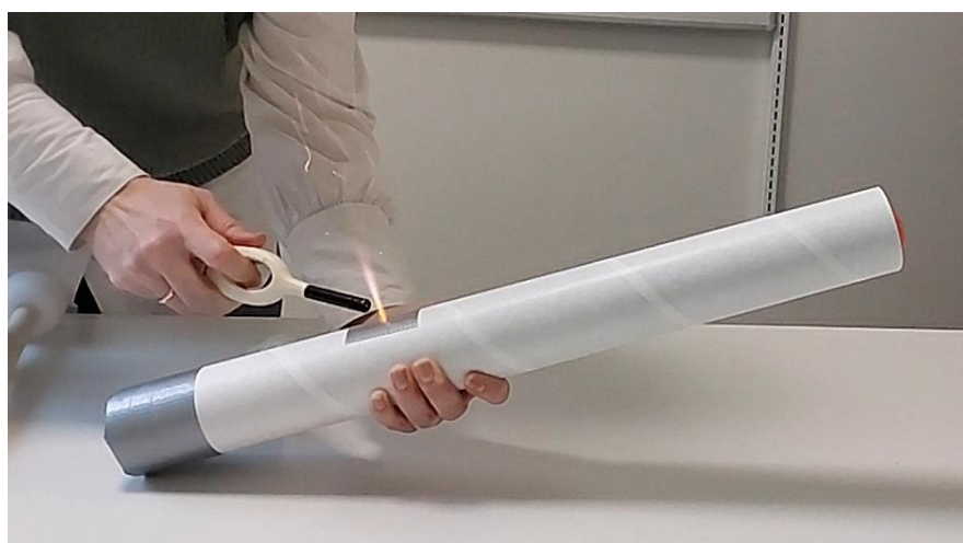
Figur 1: Den færdigbyggede gaskanon er netop blevet tændt. Stikflammen fra forbrændingen inde i røret er synlig.
