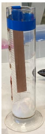
Figur 2: Cylinderglas eller måleglas med vat i bunden. Kobberpladen er tapet fast, så den ikke rører vattet.
